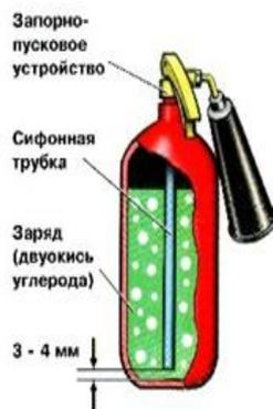
**ПРИНЦИП ДЕЙСТВИЯ** основан на вытеснении двуокиси углерода избыточным давлением. При открывании запорно-пускового устройства CO<sub>2</sub> по сифонной трубке поступает к раструбу и из сжиженного состояния переходит в твердое (снегообразное). Температура резко (до -70 °С) понижается. Снегообразная масса, попадая на горящее вещество, изолирует его от кислорода
